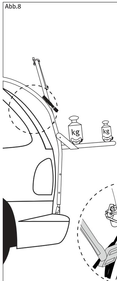
7. Wenn kein Fahrrad transportiert wird, Ausleger hochklappen und mit dem Spanngurt am Basisrahmen sichern.
