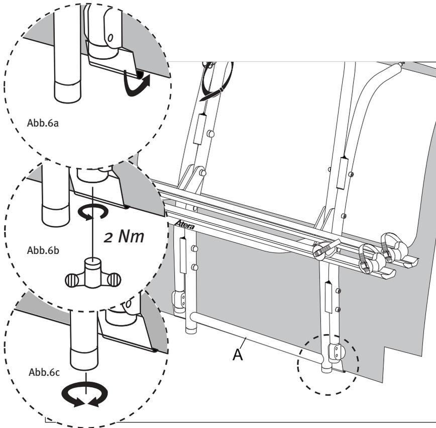
6. Untere Haltekralen mit dem Vielzahnsschlüssel öffnen. Heckklappe leicht öffnen und untere Haltekralle am Falz der Heckklappenunterkante einhaken (Abb. 6a).
