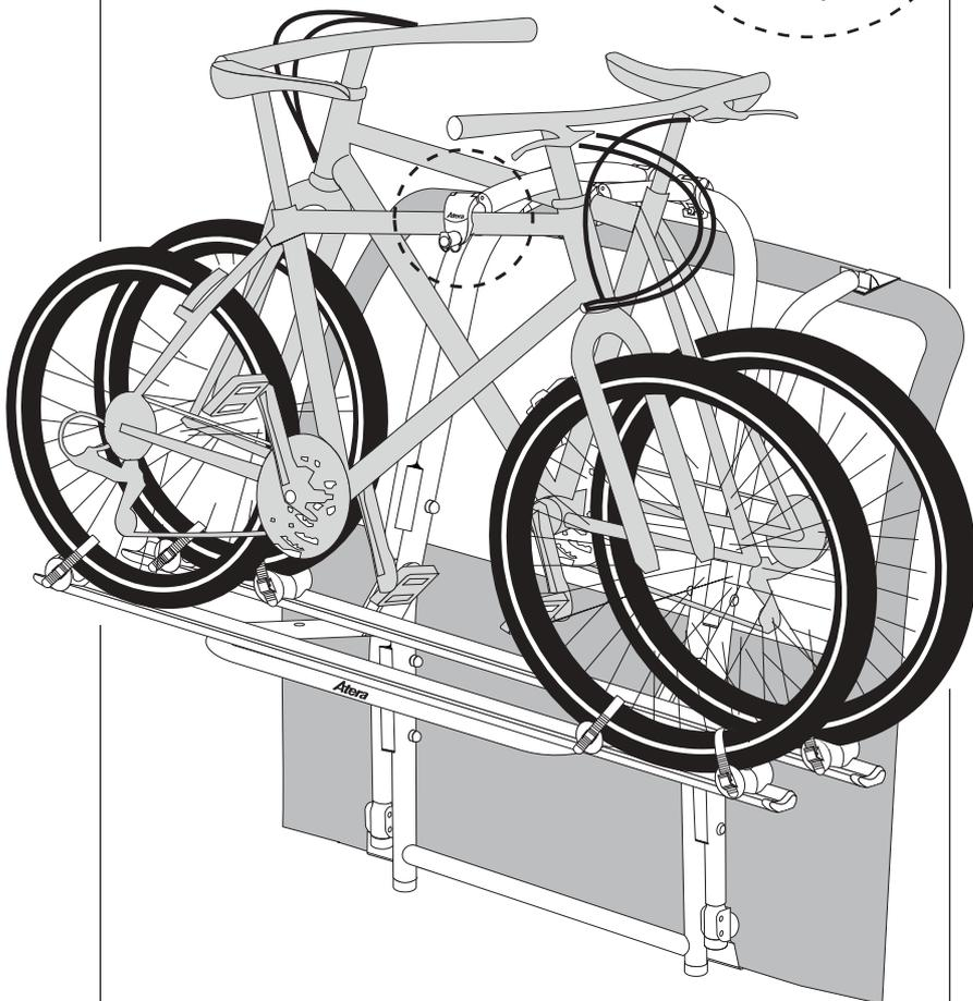
9. Die Fahrräder zum Transport mit den Reifen in die Fahrradschienen stellen.
